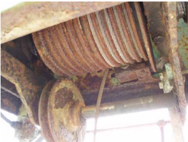
Ooit roterende onderdelen waren in roest samengeklonterd.
